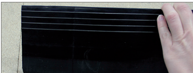
Fertige Verbindung der Gummilippe.
