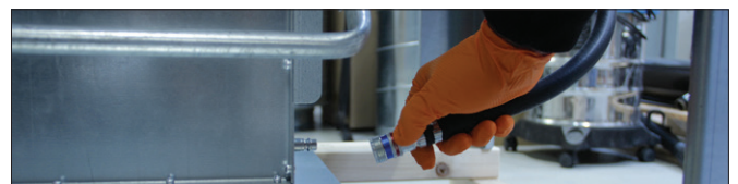
11. Schließen Sie den Unterdruckschlauch an.
