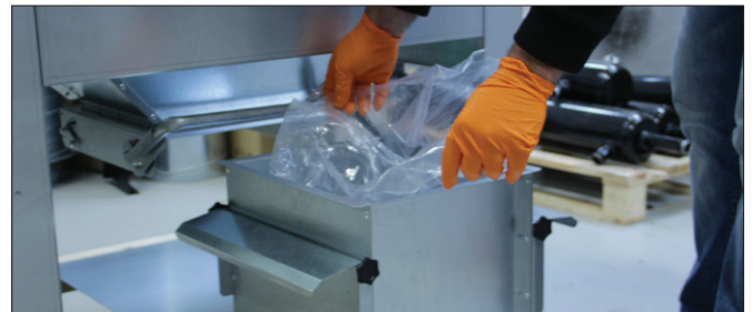
8. Fügen Sie einen neuen Beutel in den Behälter ein und achten Sie auf korrekten Sitz. Vermeiden Sie Schäden am Beutel beim einsetzen in den Behälter.
