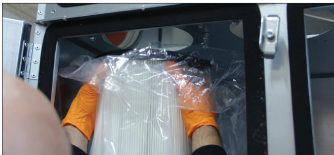
5. Das Filtermedium leicht drehen um es zu entnehmen.
