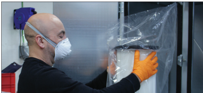
6. Die überschüssige Luft aus der Hülle drücken und mittels Binder verschließen.
