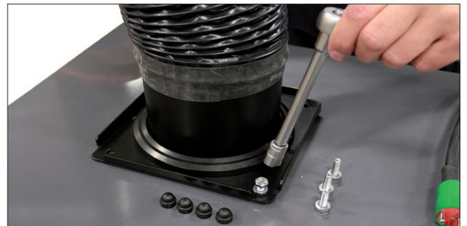
2. Verwenden Sie die mitgelieferten Schrauben und Unterlegscheiben, um den Arm zu montieren. Verwenden Sie die Schrauben-Abdeckungen.
