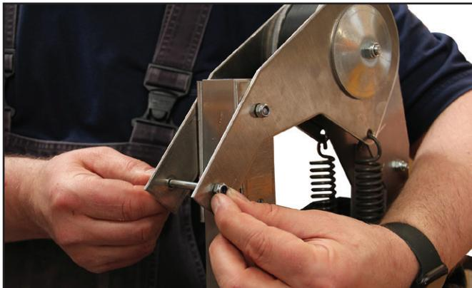
Lösen Sie die M6 Schraube mit den Fingern.
