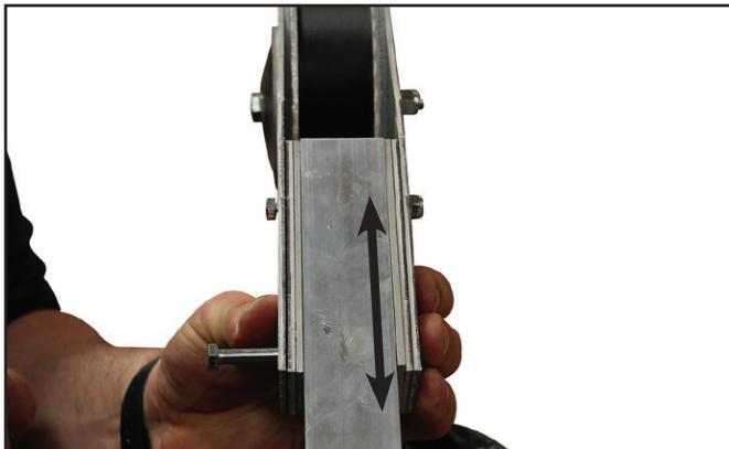
Die M6-Schraube wird entfernt und der Arm so gehalten, dass das Kniegelenk und der Arm sind bündig. Dann montieren Sie die Schraube wieder.
