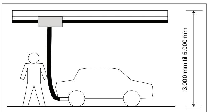
Installation des Absaugkanals: Siehe Bedienungsanleitung des Absaugkanals.
