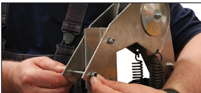
Zum Festziehen der Verbindung werden zwei M10-Gabelschlüssel verwendet.
