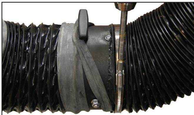
Der Schlauch wird an der Düse montiert und die Schelle wird einem 7mm Bit festgezogen.
