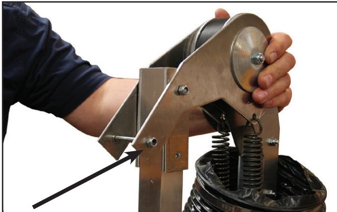
Das Aluminiumprofil des Absaugarmes muss gelockert werden.
