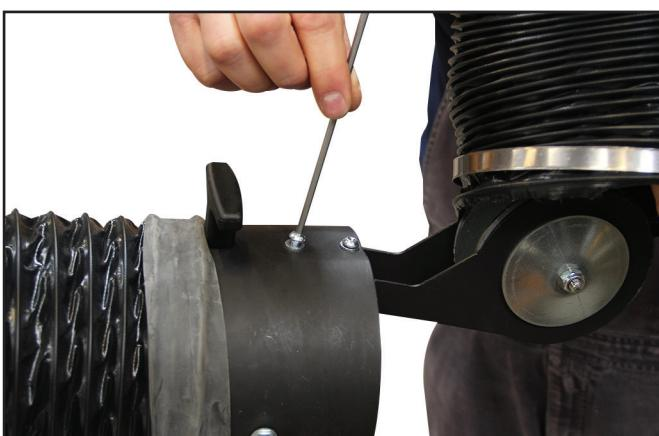
Befestigen Sie die Düse mit M6 x 25 Innensechskant-Schrauben mit Unterlegscheibe. Verwenden Sie einen Inbusschlüssel der Größe 5.
