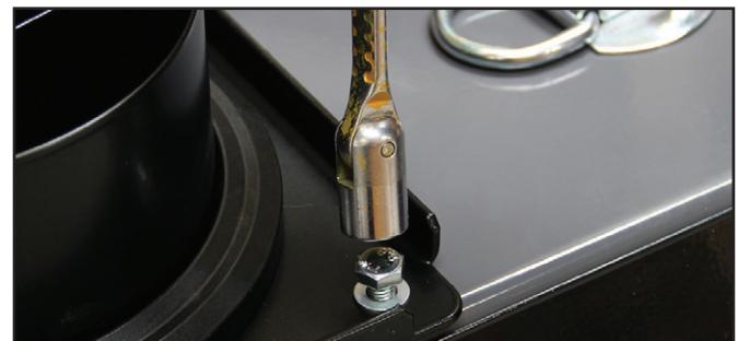
Befestigen Sie den Flansch mit den 4 Stk. M8 x 20 Schrauben und Scheiben. Montieren Sie dann den Wagen am Absaugkanal (siehe Handbuch für den Absaugkanal)
