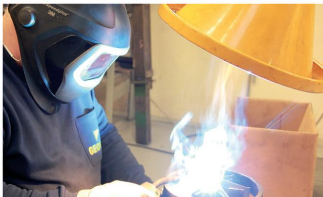
COMPACT Arm 1-2m installiert an Automatik für automatisch Start/Stop des Ventilators Lüfters und Motorklappe.
