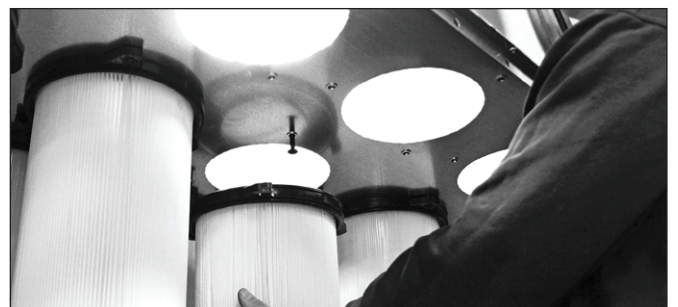
Kartuschen gedreht und aus dem Bajonettverschluss entfernt werden.
