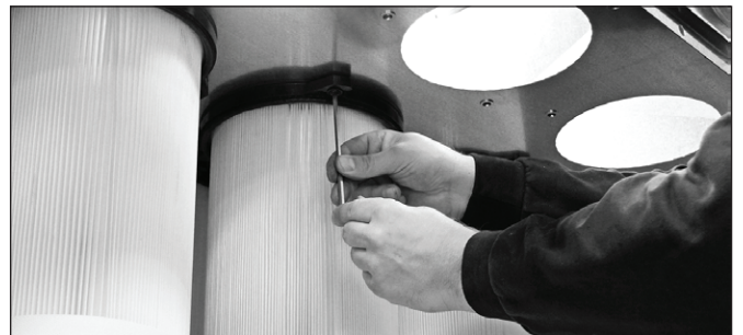
3. Lösen Sie die Inbusschrauben, mit denen die Patronen befestigt sind.
