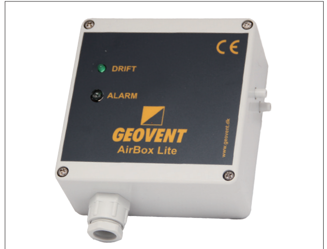
AirBox Lite - Protector de presión/protector del sistema: 20-300Pa, 100-1000 Pa y 500-2000 Pa
