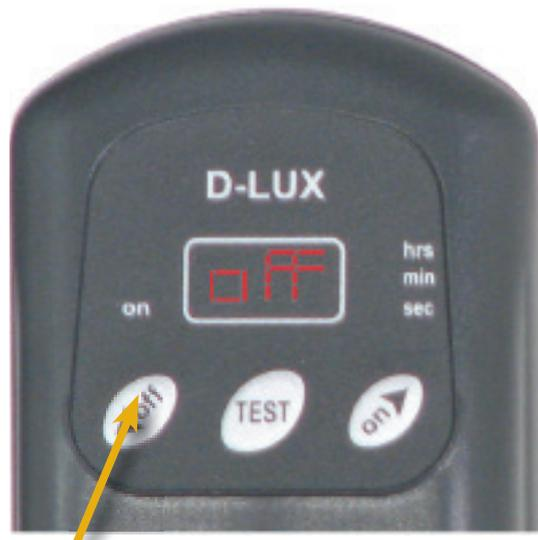
Si l'heure d'arrêt souhaitée est réglée, il suffit de ne pas appuyer sur un bouton et, après quelques secondes, l'écran se met à clignoter pour indiquer que la nouvelle heure est enregistrée.
