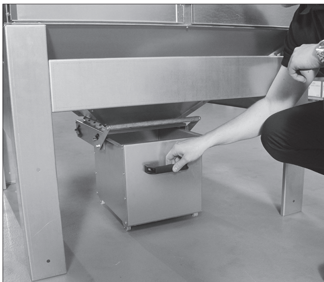
2. Spand trækkes/rulles ud og tømmes.
