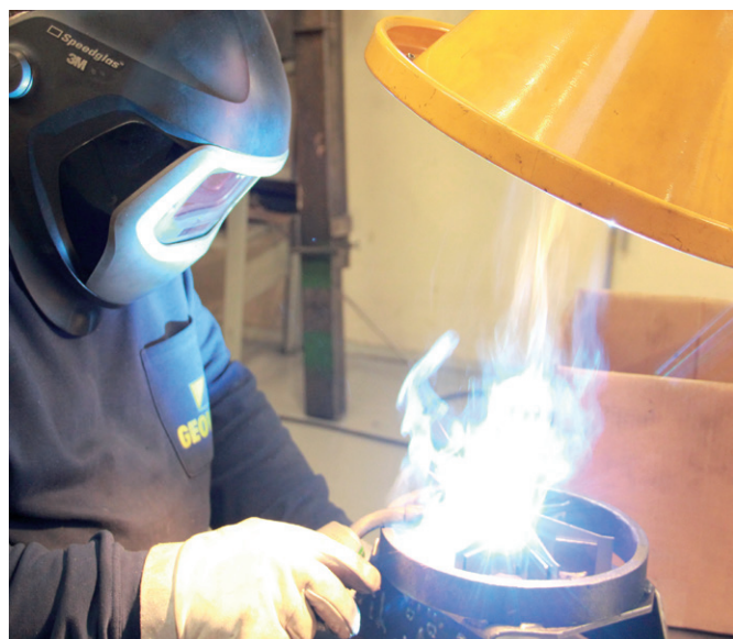
COMPACT arm 1 - 2 m inkl. automatik for automatisk start/stop af ventilator og motorspjæld.
