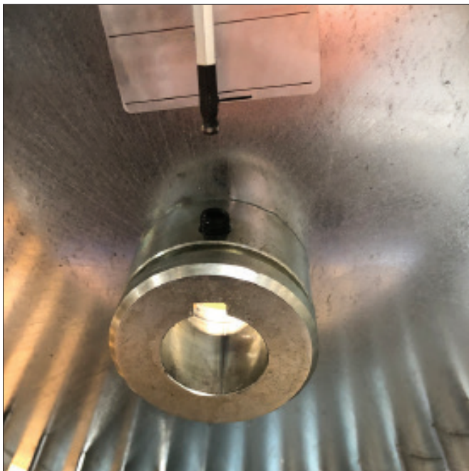
Ventilatorhjulet afmonteres ved at løsne pinolskruen. Trækkes herefter af med aftrækker.
