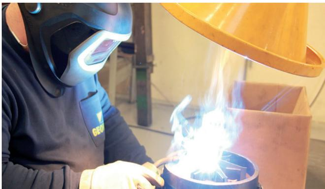
Brazo COMPACTO de 1-2m instalado y que incluye dispositivos de control automático para el arranque/parada automática del ventilador y la compuerta del motor.
