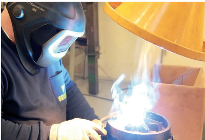
Bras COMPACT de 1 à 2 m installé et comprenant des dispositifs de contrôle automatique pour le démarrage / l'arrêt automatique du ventilateur et de l'amortisseur à moteur.
