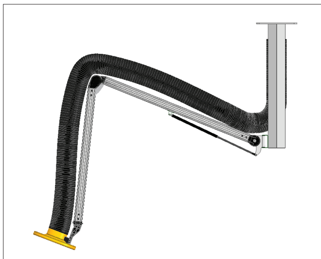
ESA arm monteret på loftkonsol drejbar 180°
